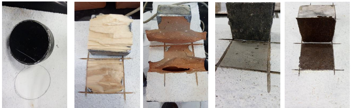
PVC Rotura adhesiva
