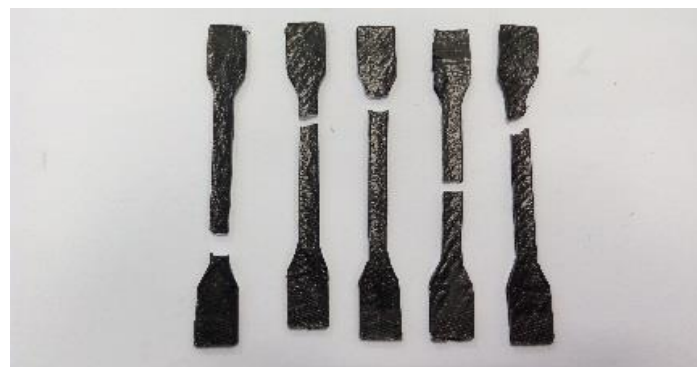
Detalle de las probetas posterior al ensayo
