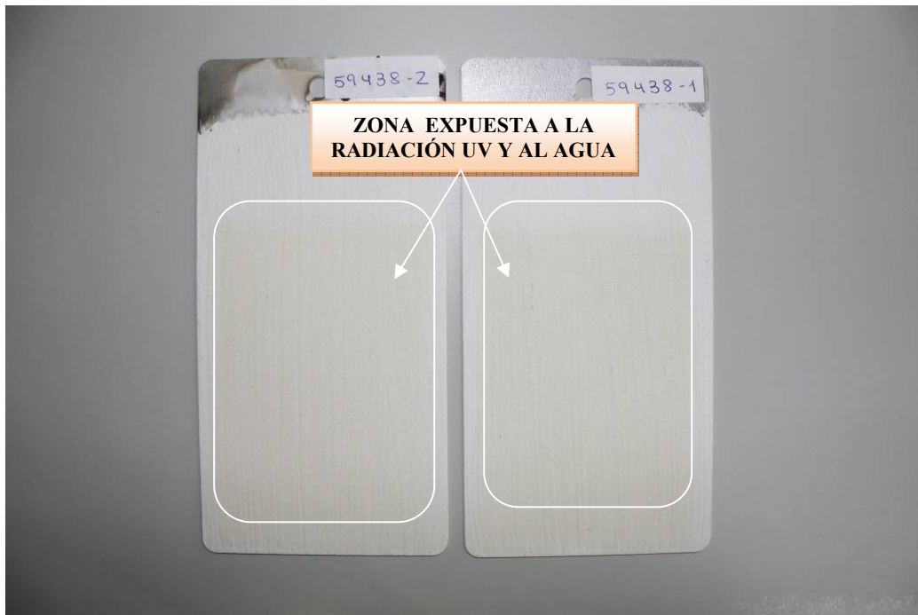
Figura 1. Resultados de la exposición a la radiación UV y al agua de la muestra 59438.
