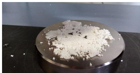
Detalle de muestras Endurpol tras el ensayo a compresión
