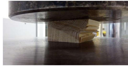
Muestras de madera tras el ensayo a compresión
