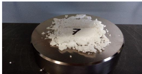
Muestras de poliestireno extruido tras el ensayo a compresión
