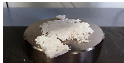
Detalle de muestras Endurpol tras el ensayo a compresión
