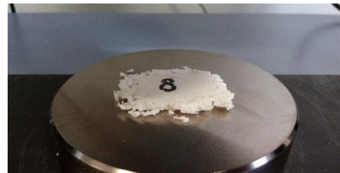
Muestras de poliestireno expandido tras el ensayo a compresión
